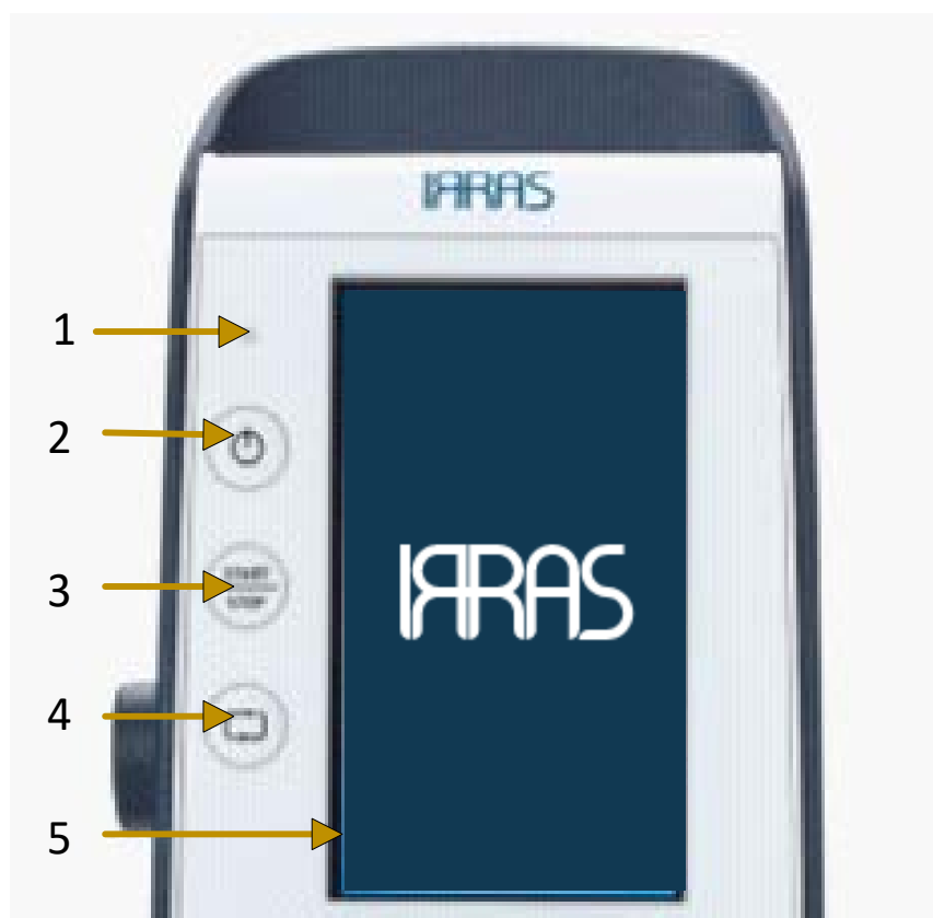
Slika 2 - IRRASflow ekran osetljiv na dodir i dugmad sa prednje strane
